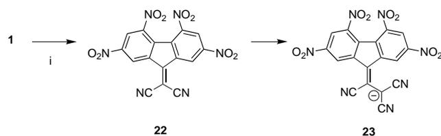
Scheme 5. i) CH<sub>2</sub>(CN)<sub>2</sub>, SiO<sub>2</sub>/DMSO, 20 °C, 12 h.
