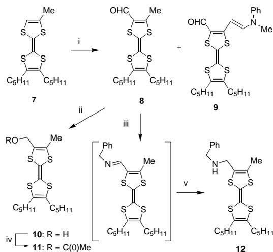
Scheme 2. i) LDA/Et<sub>3</sub>O, –78 °C, 2 h, then PhN(Me)CHO –78 °C → 20 °C, 12 h; ii) NaBH<sub>4</sub>/EtOH, 20 °C, 1 h; iii) PhCH<sub>2</sub>NH<sub>2</sub> + 4 Å MS/cyclohexane, reflux, 15 h; iv) PhCOCl + Py/MeCN, 20 °C, 2 h; v) LiAlH<sub>4</sub>/Et<sub>2</sub>O, 20 °C, 3.5 h.
